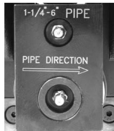
Direction du tuyau sur le bloc coulissant
